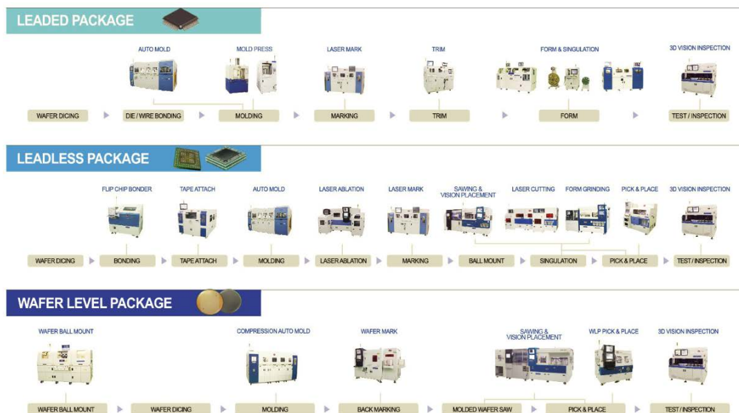
도표 6. 반도체 후공정 흐름도 및 한미반도체 보유 장비
